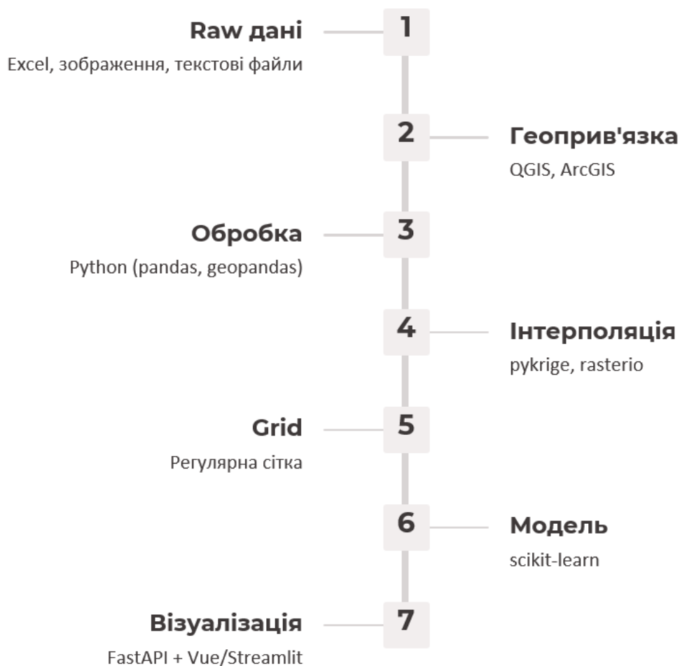
Рис. 3. Pipeline аналітичного flow для оцифровки геоданих для подальшого аналізу
