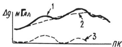
Рис. 12.7. Виміряна (1), регіональна (2) та локальна (3) аномалії сили тяжіння
